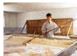
透明度抜群の海水で作る塩は、薪を燃料とした平釜で30時間かけてゆっくりと煮詰めます。常にかき混ぜないと焦げてしまうため交代制で作業しています。
